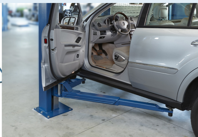
Separación óptima de la puerta con brazos asimétricos
