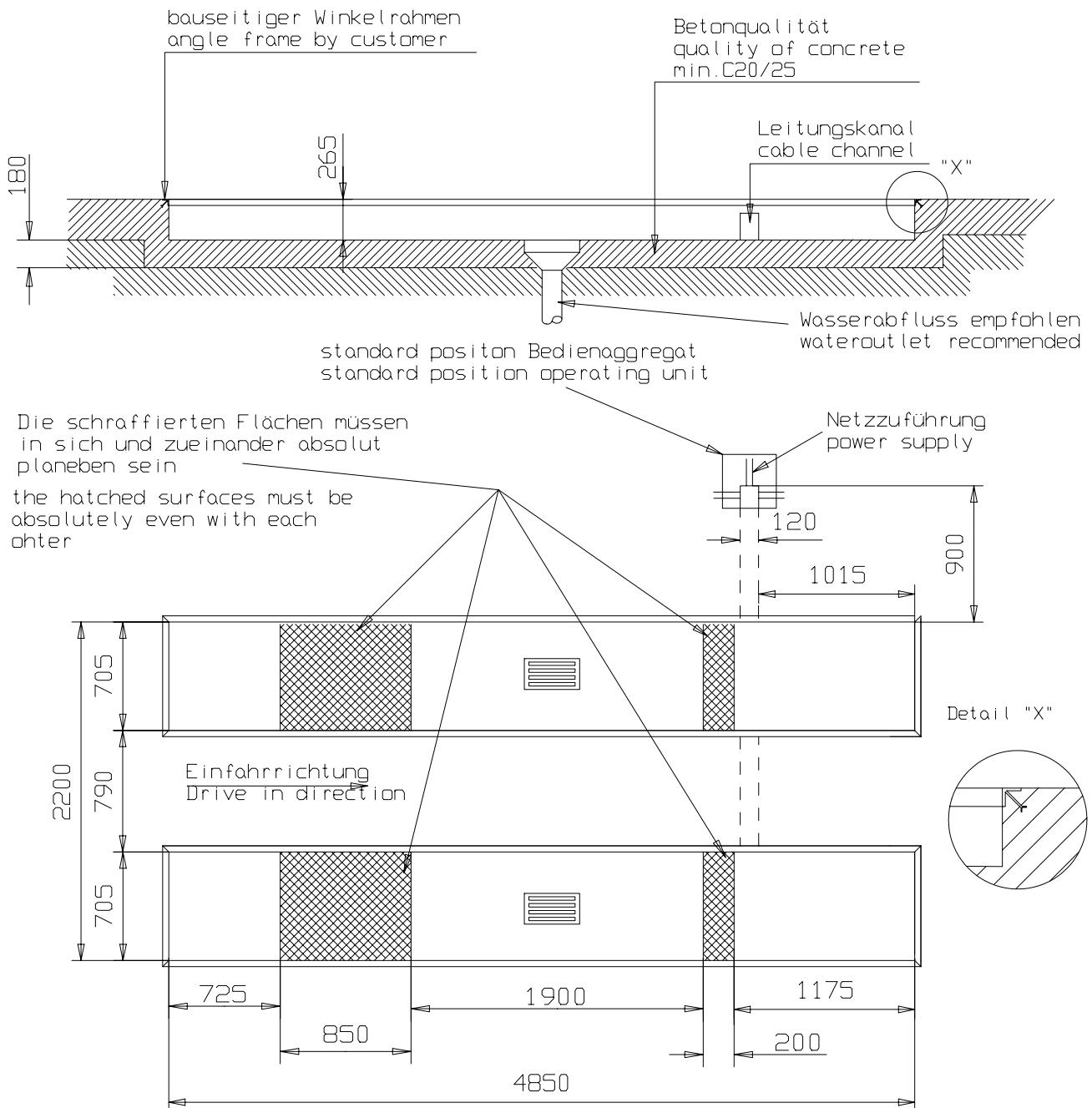
Gültig für die Serienausführung mit Stellplatten und beidseitigen Auffahrklappen
