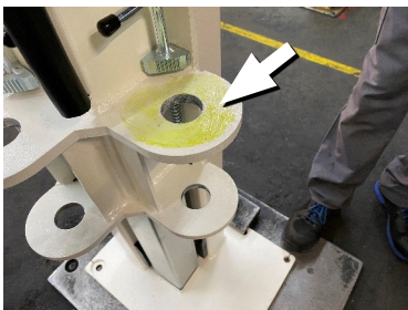
Tragarmauflage mit einem säurefreien Mehrzweckfett einfetten
