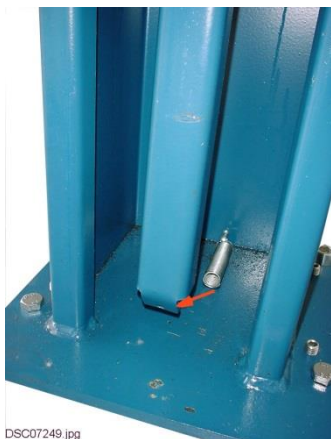
Bild 6: Zugfedern an den Klinkenleisten einhängen.
