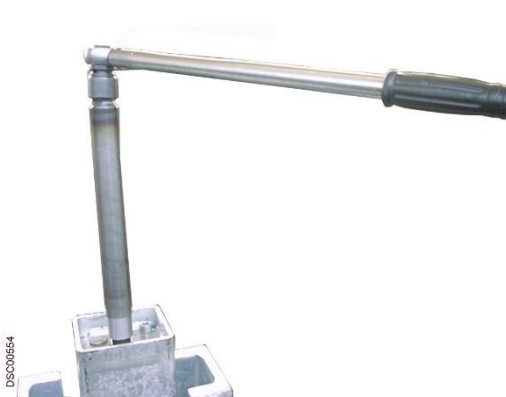
Bild 9: Lange Gewindehülse (erhältlich bei Ihrem Händler) aufschrauben und mit einem geeigneten Werkzeug (Schlüsselweite 24) im Uhrzeigersinn drehen. Den Hubschlitten ca. 5-10 cm absenken. Danach Vorgang am nächsten Hubschlitten wiederholen usw. Die Hubschlitten dürfen nur in Schritten jeweils 5-10 cm abgesenkt werden, bis die gesamte Hebebühne die unterste Position erreicht hat.
