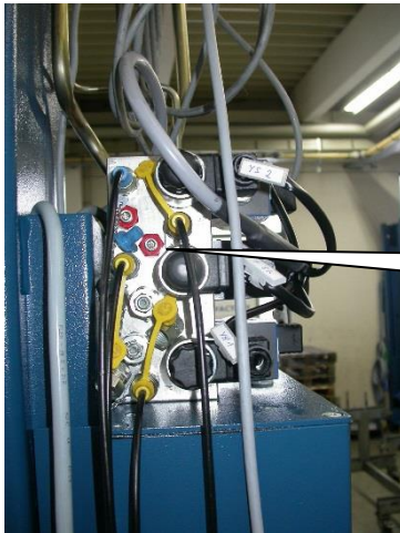
Bild 8: Die beiden rote Kontermuttern am Hydraulikblock lösen. Danach die beiden Notablassschrauben mit einem Inbusschlüssel (Größe 5) max. 1 Umdrehung gegen den Uhrzeigersinn lösen.
