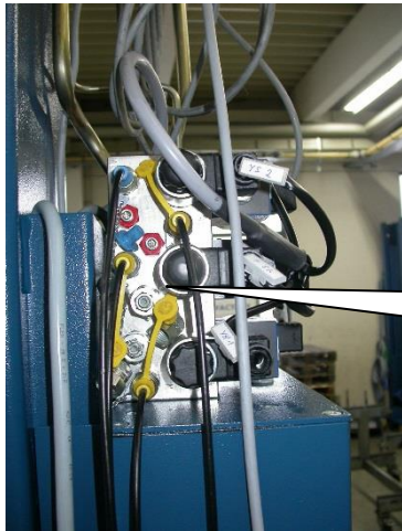
Figure 8 : Desserrer les deux contre-écrous rouges sur le bloc hydraulique. Puis desserrer les deux vis de descente d'urgence avec une clé Allen (taille 5) de max. 1 tour dans le sens inverse des aiguilles d'une montre.
