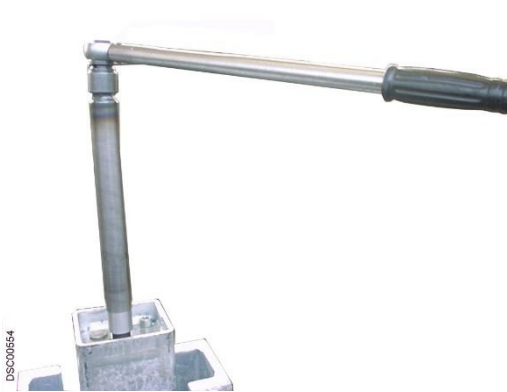
Figure 9 : Visser la douille filetée longue (disponible auprès d'un revendeur) et la tourner dans le sens horaire à l'aide d'un outil adapté (taille de clé 24). Abaisser le chariot de levage d'env. 5-10 cm. Répéter ensuite ce processus sur le chariot de levage suivant, etc. N'abaisser les chariots de levage que par incréments de 5-10 cm, jusqu'à ce que la plateforme de levage complète ait atteint la position de fin de course inférieure.
