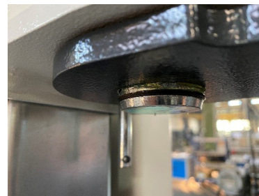
Untere Sicherung des Tragarmbolzens
