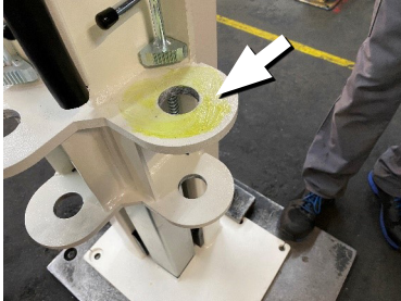
Tragarmauflage mit einem säurefreien Mehrzweckfett einfetten
