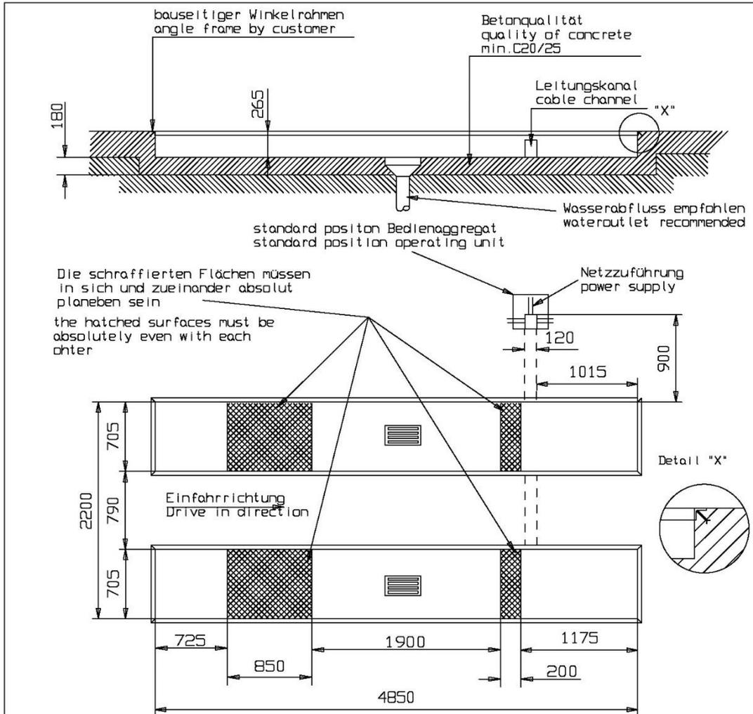
Galtig fur die Serienausfuhrung mit Stellplatten und beidseitigen Auffahrklappen
