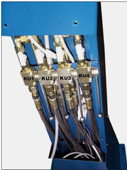
Bild 2: Kugelhähne zum Ausgleichen der Hebebühne
