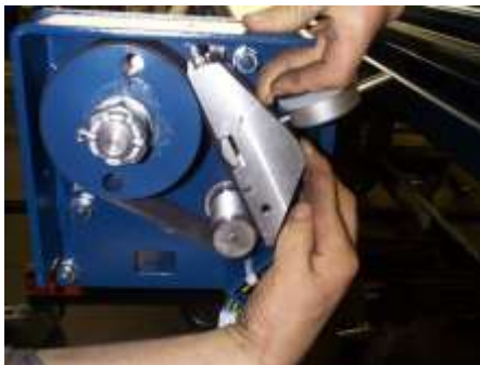
Bild 17: Messgerät am Riemen anlegen
