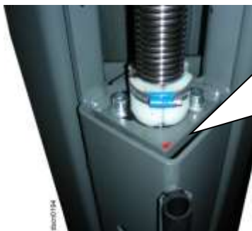
Immagine 18: Applicare dello smalto sigillante sul perno della madrevite di sollevamento
