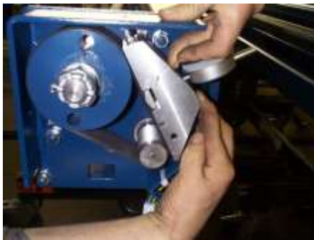
Immagine 17: Applicare il misuratore sulla cinghia
