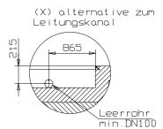
Alle Masse in mm. Alle Masse beziehen sich auf das auszuführende Fundament. Beachten Sie die Hinweise auf der Einbauwanne bzw. die separaten Einbauhinweise.
