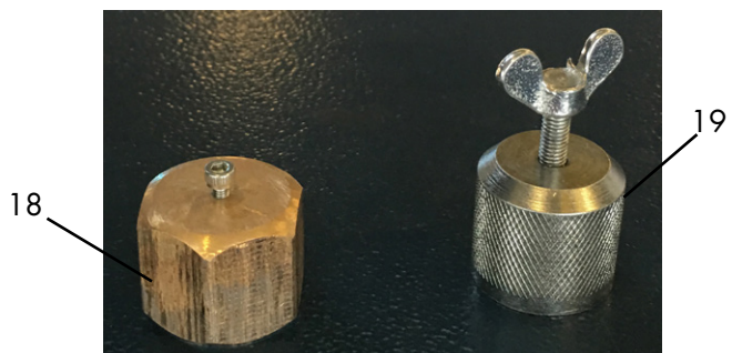
18 Aufschraubkappe mit Innensechskantschraube
