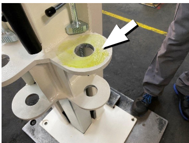
Tragarmauflage mit einem säurefreien Mehrzweckfett einfetten
