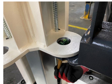
Untere Bohrung einfetten
