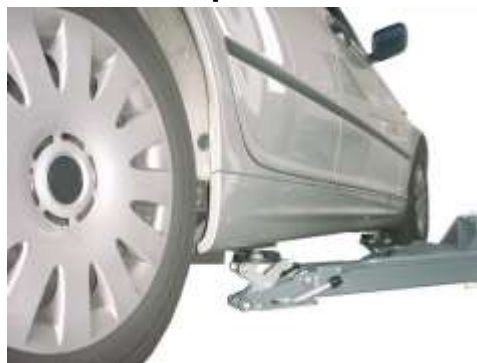
Immagine 1: Posizionare i piatti portanti solo sotto i punti di sollevamento autorizzati dal produttore.
