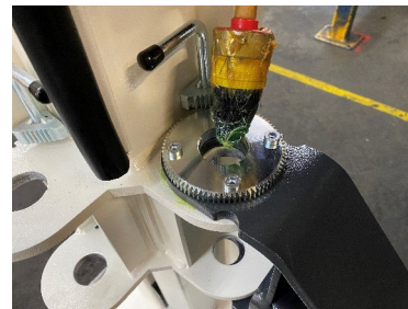
Obere Bohrung einfetten
