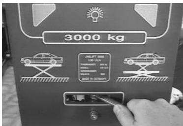
Bild 7: Umstellhebel auf Position „Radfreiheber“
