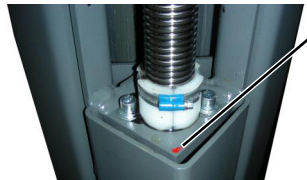
Immagine 18: Applicare dello smalto sigillante sul perno della madrevite di sollevamento
