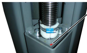
Figure 18 : Marquer la broche de l'écrou de levage avec du vernis de scellement
